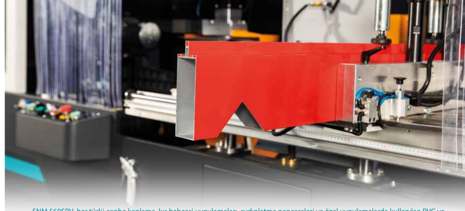
SNM 560SRV her türlü cephe kaplama, kış bahçesi uygulamaları, aydınlatma pencereleri ve özel uygulamalarda kullanılan PVC ve alüminyum kasa, kanat, orta kayıt ve lento profillerine istenilen açı ve ölçüde boşaltma işlemi yapmak amacıyla tasarlanmıştır. Kesilecek profil makine tablosu üzerine sabitlenerek ve 2 adet testerinin bağlı olduğu hidro-pnömatik kesme jeddisi otomatik olarak hareket ederek kesme ve boşaltma operasyonları yapılmaktadır.
